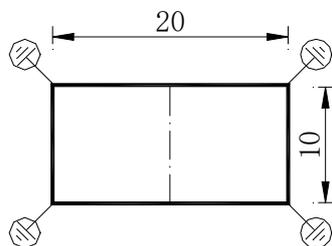
基础防雷：4 个引下线桩： $4 \times 1 \times 80 = 320$  元。
