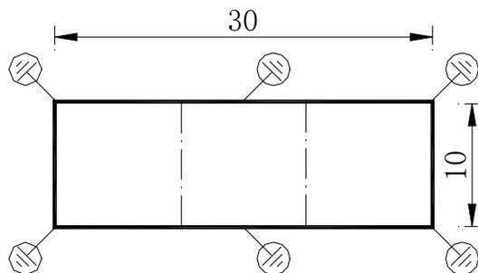
基础防雷：6 个引下线桩一次检测： $6 \times 1 \times 80 = 480$  元；
