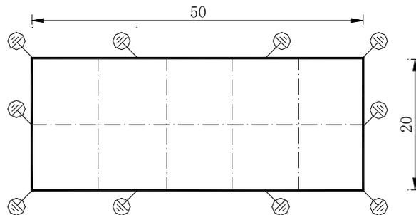
基础防雷：10 个引下线桩按一次检测： $10 \times 1 \times 80 = 800$  元。
